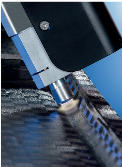
Erklärtes Ziel des Leichtbaus ist es, Ressourcen bei der Herstellung und Nutzung eines Produkts einzusparen. Die Plasmabehandlung ermöglicht hierbei oftmals neue Materialkombinationen. © Plasmatreteat
